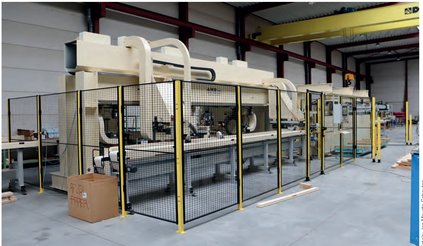
De machine voor het razendsnel produceren van complete bouwpakketten voor blokhutten en tuinschuurtjes.
