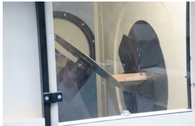
In de Do-All worden werkstukken opgesloten voor bewerking. Daardoor neemt de precisie toe en kan het stof maximaal worden afgezogen.
