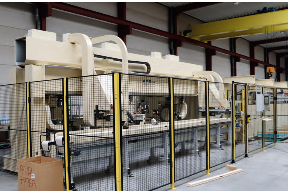
La machine pour la production rapide de kits complets pour les cabanes en bois et les abris de jardin.
